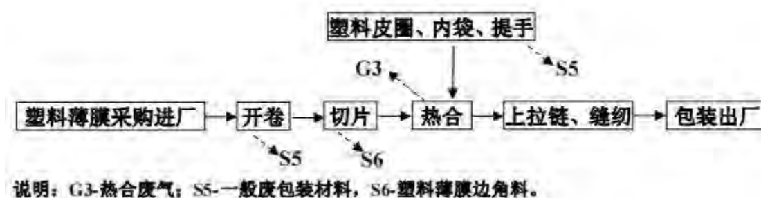
图 2-3 塑料包装袋生产工艺流程图
