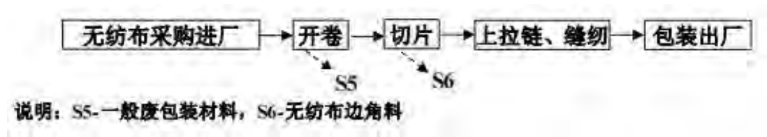
图 2-4 无纺布包装袋生产工艺流程图
